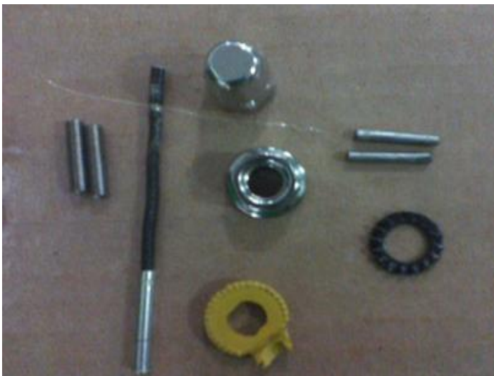
Figura 41: Componentes de regulagem e segurança das rodas traseira e dianteira
