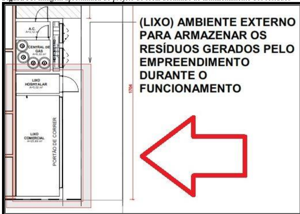
Figura 58: Imagem aproximada do projeto do local destinado ao armazenamento dos resíduos
