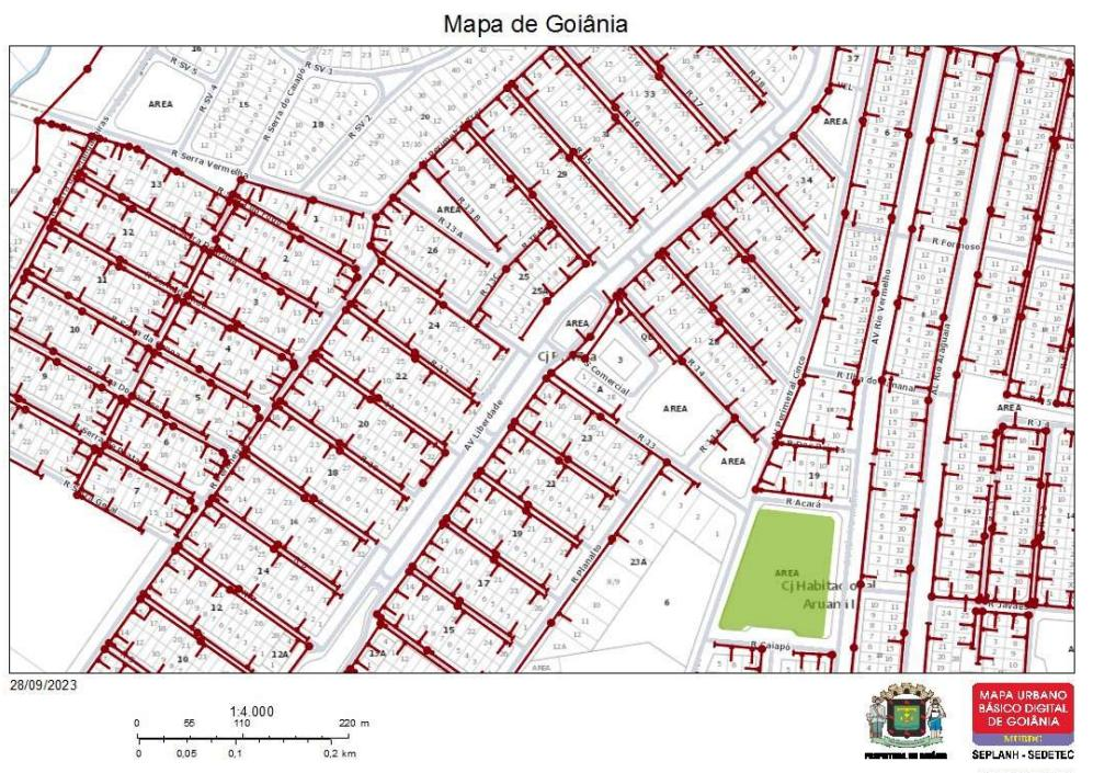
Figura 22: Rede Coletora de Esgoto. Fonte: Mapa Digital Fácil, Prefeitura de Goiânia.
