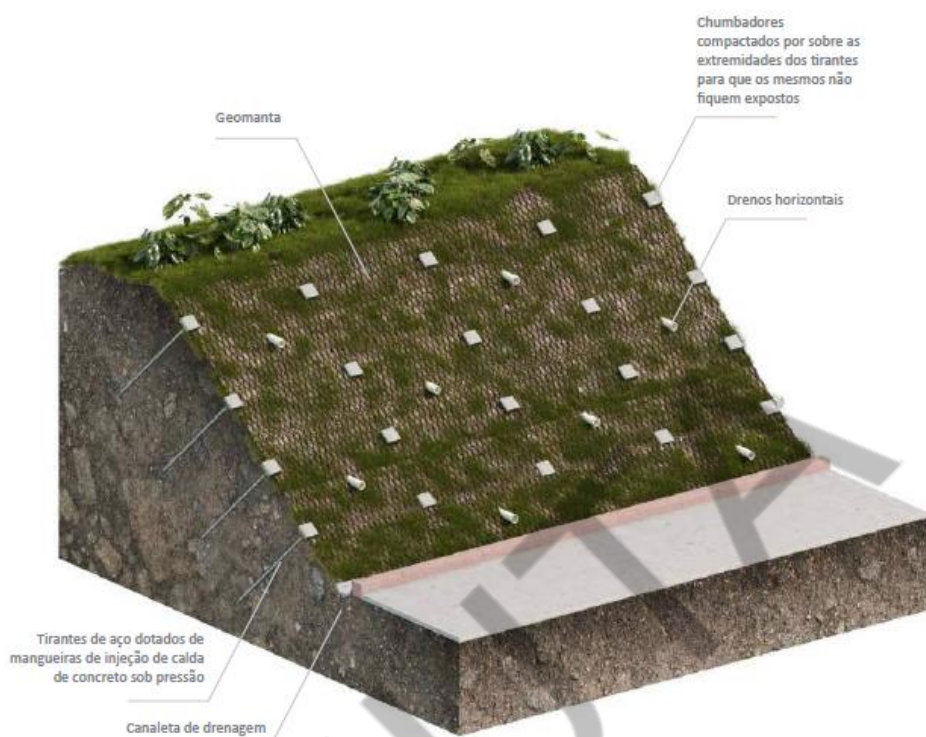
Figura 34 – Solo Grampeado Verde (Fonte: Guajava, 2023 apud Sandre et al., 2024).
