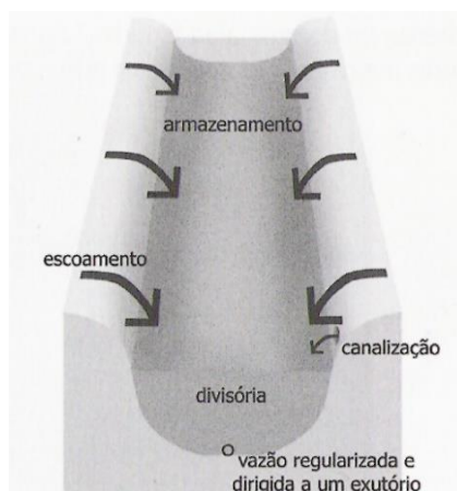
Figura 3 - Esquema de funcionamento de vala de retenção (adaptado de Azzout et al., 1994).
