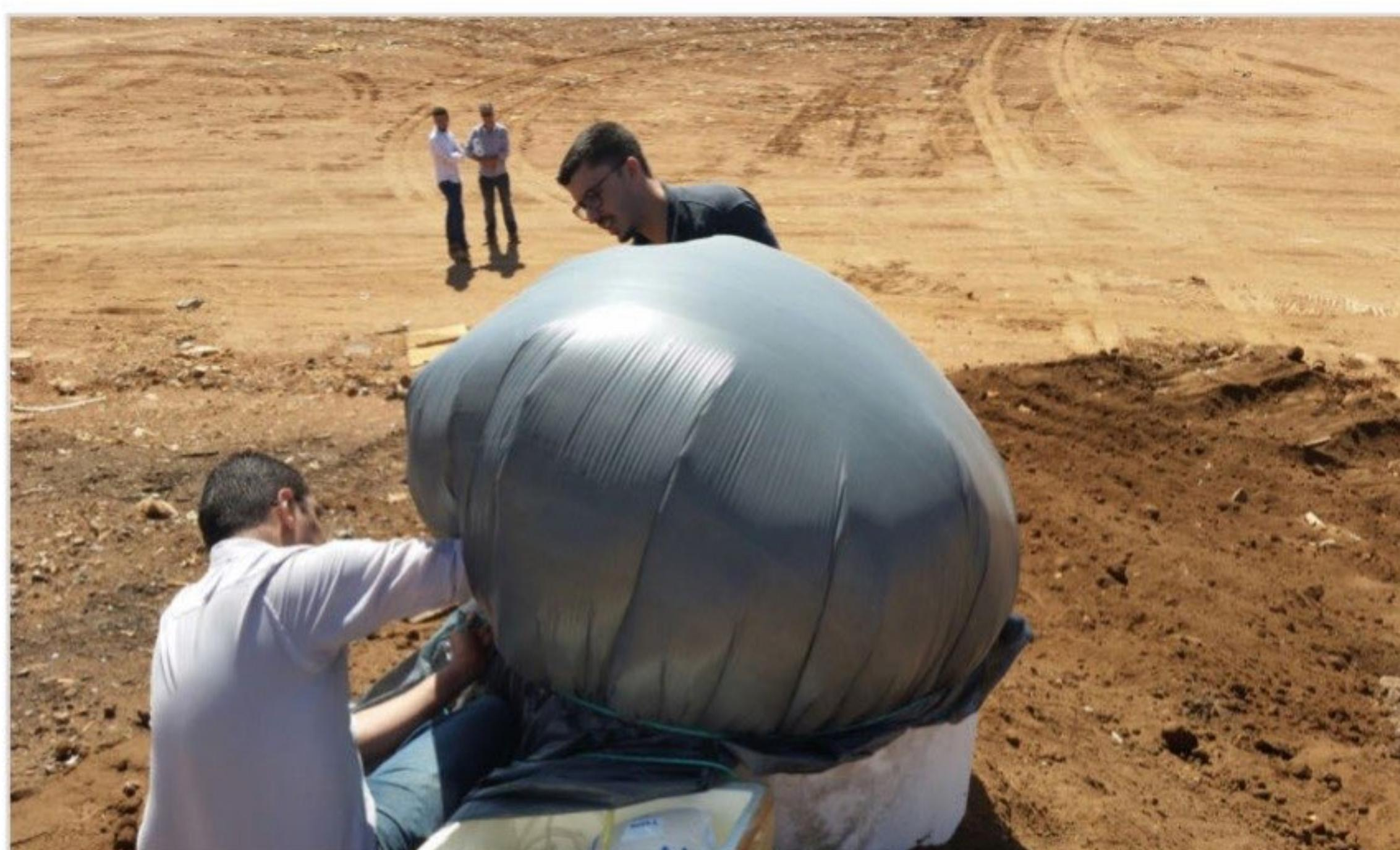
**Figura 10: Registro do momento da coleta de biogás em um queimador do Aterro de Goiânia para posterior ensaios laboratoriais para identificação da composição.**
