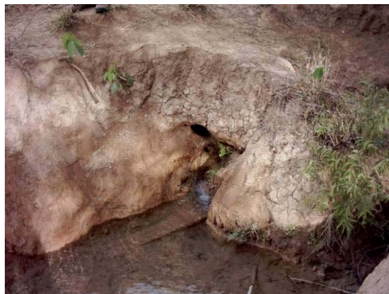
Fig. 3.21 – Esta surgência, pelo aspecto, sugere que a concentração do fluxo esteja condicionada a um piping .
