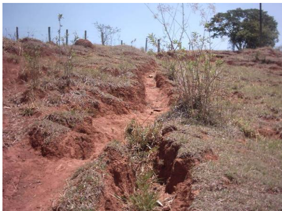
Fig. 4.6 – Processo de sulcamento pela passagem de gado, que tem como resultado a infiltração das águas pluviais com posterior ruptura do maciço.
